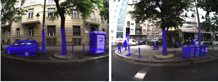
3. ábra. A javasolt kamera-Lidar kalibrációs eljárás eredménye [1].
