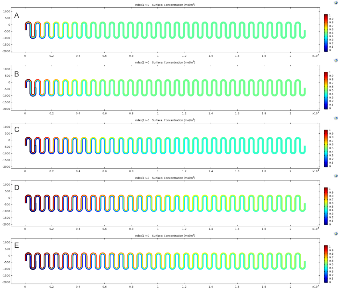
3.4. ábra – Numerikus diffúzió jelensége a kígyó keverőn szemléltetve. A keverőt egyre finomabb hálóbontással modellezve jól látszik, hogy a jól kevert régió (zöld színnel) egyre később jön létre a csatornáknban. A konvergencia vizsgálat utolsó két modellje között a különbség nehezen észrevehető.
